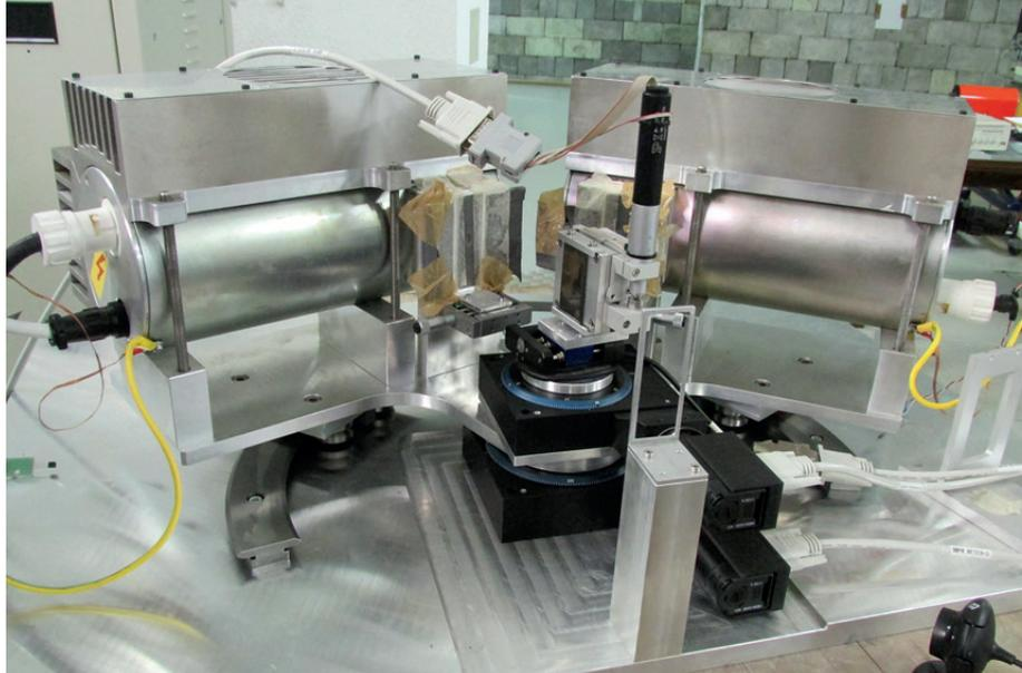
Fig. 5 Fotografia del sistema di produzione del fascio quasi-monocromatico.
