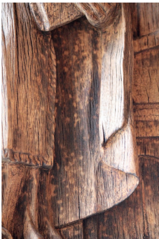
Fig. 17 - Alterazioni cromatiche della superficie, dovute probabilmente a attacchi biologici.
