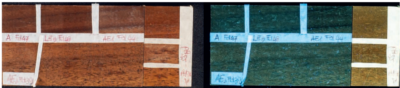
Fig. 14 - Esempio di provino con trattamento pigmentato. A sinistra l'immagine in luce visibile e a destra in luce ultravioletta. I campioni sono divisi in due parti, la cui più piccola a destra è stata invecchiata in solar box. Tutti i campioni hanno evidenziato un aumento della fluorescenza del substrato ligneo indipendentemente dalla natura del trattamento applicato. Sul campione sono presenti i tasselli delle prove di pulitura. Si evidenzia come dopo l'invecchiamento in solar box, nonostante la schermatura del pigmento, compare la fluorescenza del legno sottostante mentre esteticamente nel visibile la superficie rimane inalterata.
